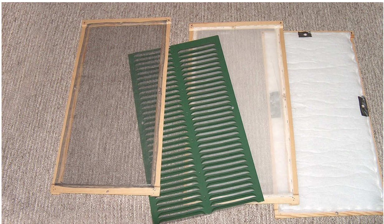
Hyttysverkko, säleikkö, valoverho ja siitepölysuodatin mittauksia varten kehystettynä.
